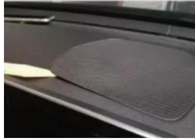
12. Hebeln Sie die zentrale Hupenabdeckung des Originalfahrzeugs ab
