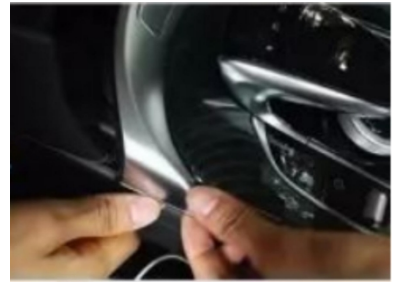
3. Entfernen Sie die silberne Verkleidung der originalen Mittelarmlehnenbox.
