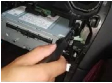
17. Entfernen Sie die Befestigungsschrauben
