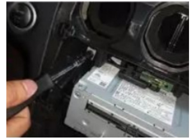
18. Entfernen Sie die Befestigungsschrauben
