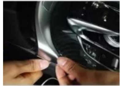
2. Ausbau der silbernen Verkleidung der originalen Mittelarmlehnenkonsole
