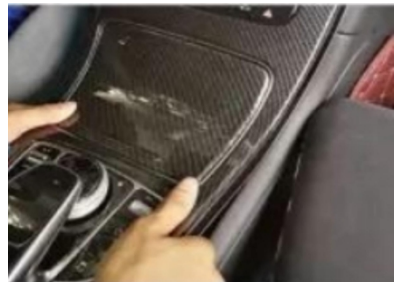
5. Befestigungsschrauben entfernen 6. Heben
