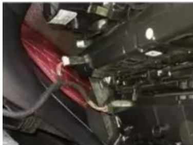
11. Ziehen Sie den Originalstecker ab.
