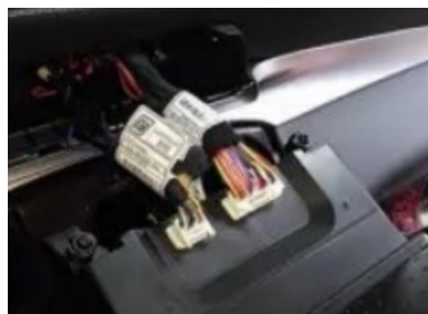
26. Schematische Darstellung des Anschlusses unseres Navigationskabelbaums unseres Kabelbaums an den Kabelbaum des Original-Hosts
