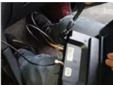
25. Entfernen Sie die beiden Schrauben des Originalbildschirms und montieren Sie unseren Bildschirm.
