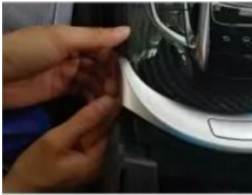
1. Entfernen Sie die silberne Verkleidung der originalen Mittelarmlehnenbox.
