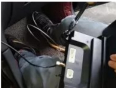
25. Entfernen Sie zwei Schrauben des Original-Autobildschirms und installieren Sie unseren Monitor
