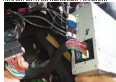
27. Verbindung zwischen unserem Kabelbaum und dem originalen Fahrzeug-Host-Kabelbaum
