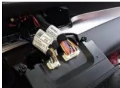
26. Schematische Darstellung unseres Navigationskabelbaumanschlusses
