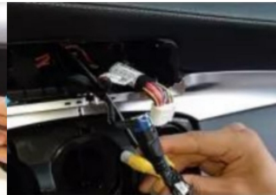
24. Das LVDS-Kabel des Originalfahrzeugs wird mit unserem Kabelbaum verbunden
