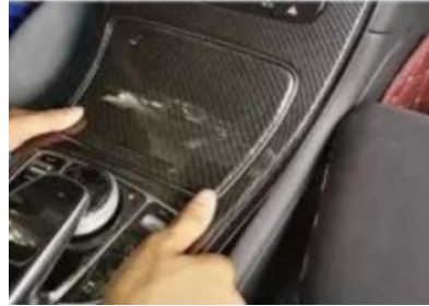
6. Heben Sie die zentrale Steuerung des Originalfahrzeugs leicht an.
