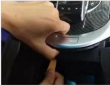
4. Entfernen Sie die silberne Verkleidung der originalen Mittelarmlehnenkonsole.
